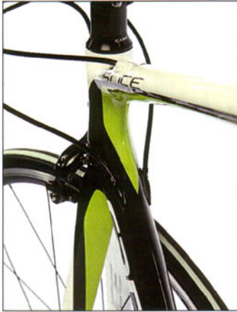
Zo hoort het: alle kabels door het frame
